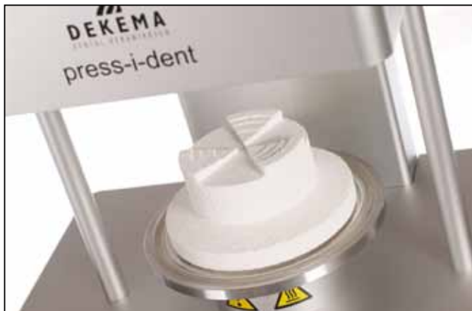
Fig. 9 Tavolo di pressatura: il tavolo di pressatura ottimizzato del forno di cottura Dekema è frutto delle più recenti conoscenze riguardo alla distribuzione della temperatura all'interno della camera di combustione dei forni per cottura ceramica e, grazie alla sua speciale superficie d'appoggio puntiforme, consente una circolazione del calore di irradiazione all'interno della camera di combustione. Ciò consente una ripartizione uniforme della temperatura all'interno della muffola e contribuisce a risultati qualitativamente migliori
