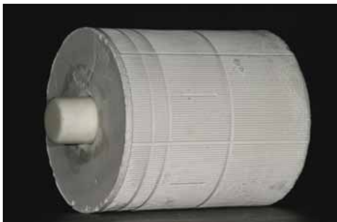
Fig. 15 La superficie della muffola, in caso di utilizzo di un formatore per muffola in silicone, crea una superficie allargata. In teoria si presume che l'irradiazione del calore della serpentina riscaldante possa in tal modo riscaldare la muffola in modo migliore. In pratica, tuttavia, questo fattore ha un'influenza molto ridotta; la conducibilità termica della massa di rivestimento è molto più decisiva ai fini del risultato complessivo
