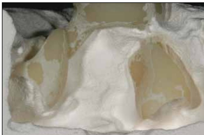
Fig. 16 Sezione trasversale della muffola: in sostanza, più la massa di rivestimento è bollente, più spesso è lo strato di reazione. Dato che una muffola è sempre più fredda nel suo nucleo interno che sulla parete esterna, la formazione dello strato di reazione risulta qui inferiore
