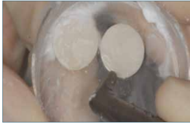
Fig. 5 I campioni del Gruppo A2 sono stati trattati con tecnica Air Polishing addizionata Perio Soft con protocollo di 5" a distanza di 5-3 mm dal dischetto con un'inclinazione di 30°/60°.
