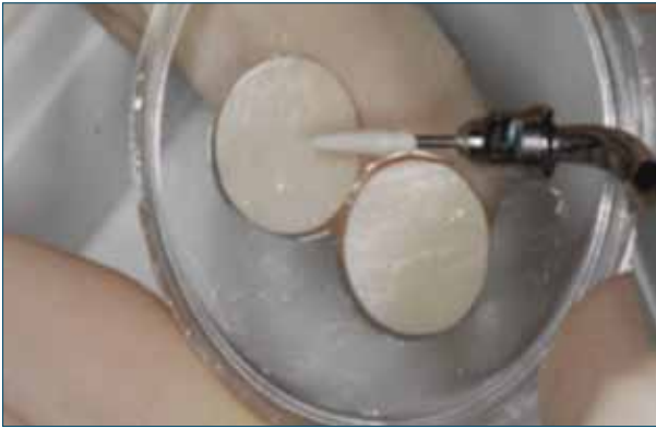
Fig. 4 I campioni del Gruppo A1 sono stati trattati con punta in Peek (EMS) con protocollo di tempo 5" con movimenti orizzontali.
