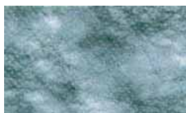
La superficie del tessuto PP30 - 30 g/m2 usato per la fabbricazione del camice.
