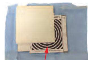
Aprire il pacco cartaceo ed estrarre il foglio test situato al centro. Viraggio dopo la sterilizzazione.
