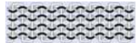
Tessitura brevettata Ribbond, fornisce una rete di fibre intrecciate tessute che ferma la propagazione delle incrinature grazie al trasferimento multidirezionale delle forze
