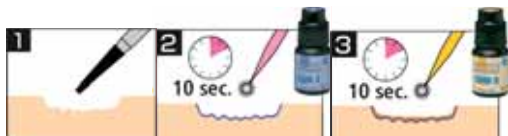
Irruvidire con diamantate. Applicare CRB1 e lasciare 10 sec., CRB2 10 sec., fotopolimerizzare con alogeno 20 sec.
