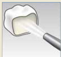
1. Sabbatura con Al 2 O 3 sciacquo, asciugatura.
