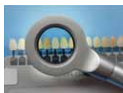
Rite Lite 2 con filtro polarizzante applicato.
