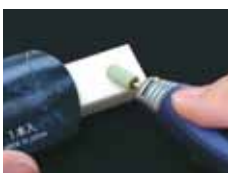
Adjuster: Dura-Green DIA premuta con un movimento di molatura
