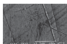
1. Micrografia SEM di una superficie aurea lucidata (3700 x).
