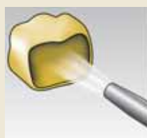
1. Sabbiatura con Al 2 O 3 sciacquo, asciugatura.
