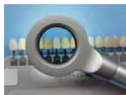
RiteLite 2 con filtro polarizzante applicato.
