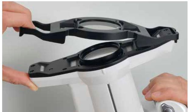
Applicando il filtro per la polarizzazione incrociata, EyeSpecial C-IV permette di guardare all'interno del dente: cromia, effetti interni della luce e caratteristiche individuali dei denti diventano visibili senza venir distorti dai riflessi di luce che si creano sulla superficie dello smalto. Con il filtro polarizzatore si riescono a valutare in modo più accurato anche gli effetti cromatici dei tessuti duri e molli.
