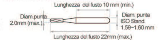
(specifiche delle fresa con testina in miniatura:
