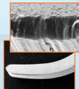
Bordo tagliente di una curette tradizionale non rivestita e ingrandimento del tagliente dopo il test.
