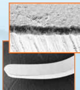
Bordo tagliente della curette LM Sharp Diamond™ e ingrandimento del tagliente dopo il test.
