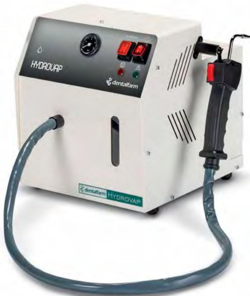
Generatore di vapore con caldaia in acciaio inox di grande dimensione, perfettamente coibentata, dotata di resistenza esterna allo scopo di evitare l'azione deleteria del calcare. Il caricamento dell'acqua è manuale, deve quindi essere effettuato a freddo. L'erogazione del vapore avviene per mezzo di una pistola ed è a flusso regolabile. La pressione di utilizzo è 6 BAR e la temperatura dell'acqua è di 155°, parametri ampiamente sufficienti per sgrassare e pulire a fondo qualsiasi superficie.
