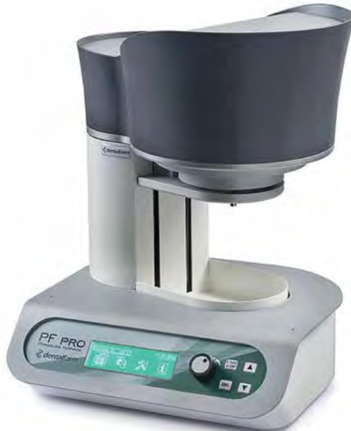
Nella camera di riscaldamento l'irraggiamento passa attraverso un filtro al quarzo per utilizzare maggiormente gli infrarossi emessi ed ottenere così un riscaldamento progressivo dall'interno del manufatto, con conseguente evaporazione controllata dell'umidità. La temperatura è controllata da una speciale termocoppia che non si ossida e non richiede quindi periodiche operazioni di taratura
