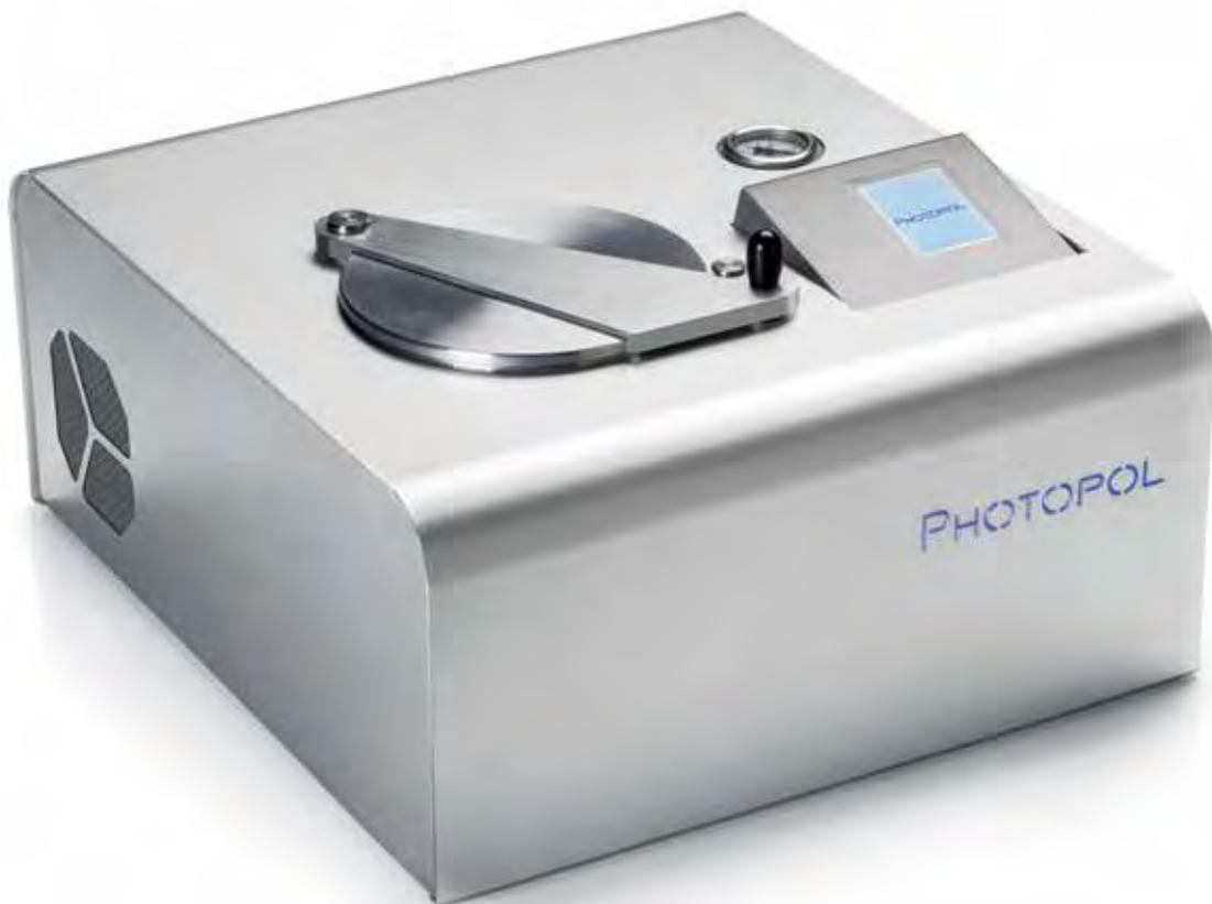
PHOTOPOL VACUUM+GAS (A5408V) è dotato di 6 speciali circuiti da 8 LED (Hi-Power SMD) progettati ognuno con un apposito riflettore per sfruttare al massimo la potenza di irraggiamento emessa. Lo spettro operativo permette di trattare gli oggetti prodotti da stampanti 3D che operano ad una lunghezza d'onda sia di 385nm che di 405nm.
