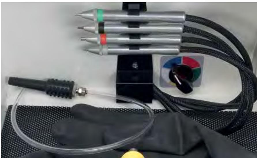
Camera di lavoro modello **BASE EVO** con proiettore di sabbatura a riciclo (giallo), quattro microproiettori per abrasivo a perdere ed il pratico manipolo di soffiaggio
