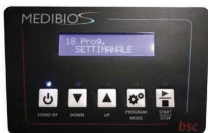
Il pannello di comandi permette di programmare le operazioni in modo facile e intuitivo e di trasferire le registrazioni delle erogazioni tramite porta seriale.
