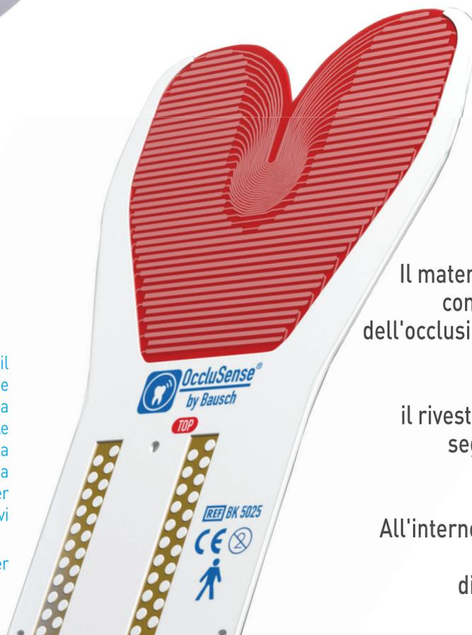
OccluSense® il sensore di pressione tecnologicamente avanzato permette la registrazione oclusale a 256 livelli di pressione.
