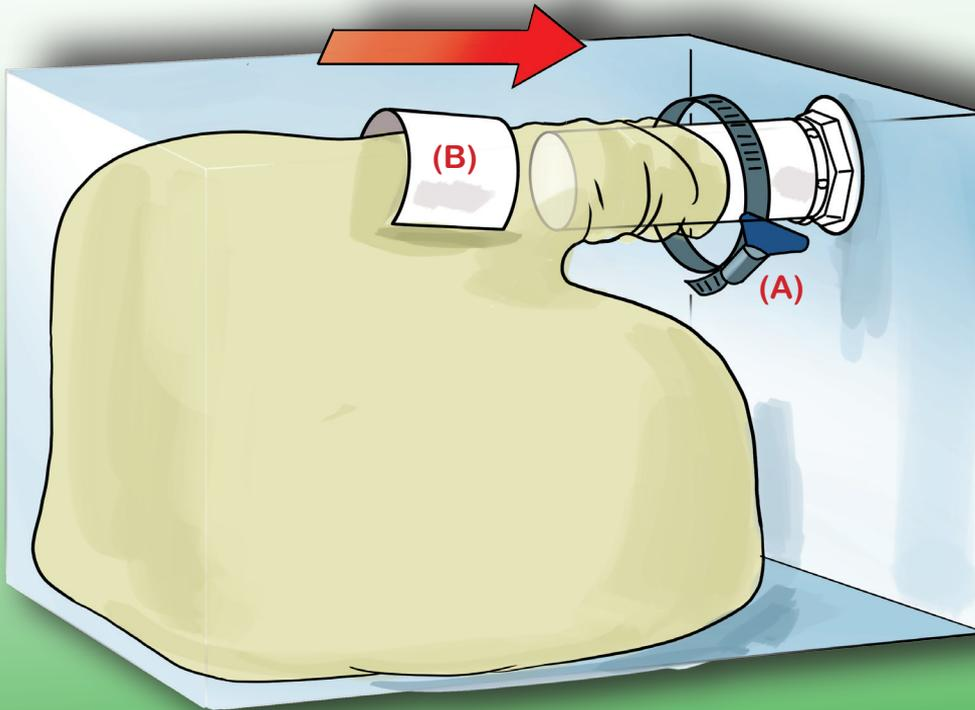
Infilare il sacchetto sul tubo e stringere la fascetta metallica (A) sopra di esso fino a sigillarlo ermeticamente. Arruffare il sacchetto in eccesso sul tubo in modo da posizionarlo centralmente alla cassetta e bloccarlo con l'apposita fascetta plastica (B).
