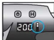
La luce rossa lampeggiante nell'indicatore di carica segnala che la batteria è scarica e che deve essere ricaricata completamente.
