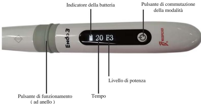
5.1 In modalità spegnimento (manipolo), premere il pulsante di commutazione della modalità per far entrare il manipolo in modalità standby. In modalità standby, premere leggermente il pulsante di commutazione della modalità per selezionare il livello di potenza.
